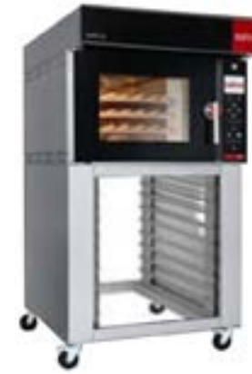
05. KWik-co Oven KX5+H KX5+H + Tray 40*60빵팬 5개 작업가능(급배수 필요) 크기(mm) :915x1059x695 전원/ 전력 : 380V 3상4선 7.5KW
