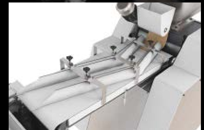
다중 조각 라인의 중심에 위치한 Divider는 PM-6과 유사한 특성을 가집니다. 높은 생산 능력으로 인해 피타 빵 제조에 있어 주요 제품으로 자리 잡고 있습니다
