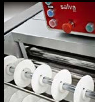
고내구성 열가소성 수지로 만든 회전식 멀티 커팅 드럼은, 도구를 바꾸지 않고 고도 4개, 6개, 7개 또는 10개의 절단을 할 수 있습니다
